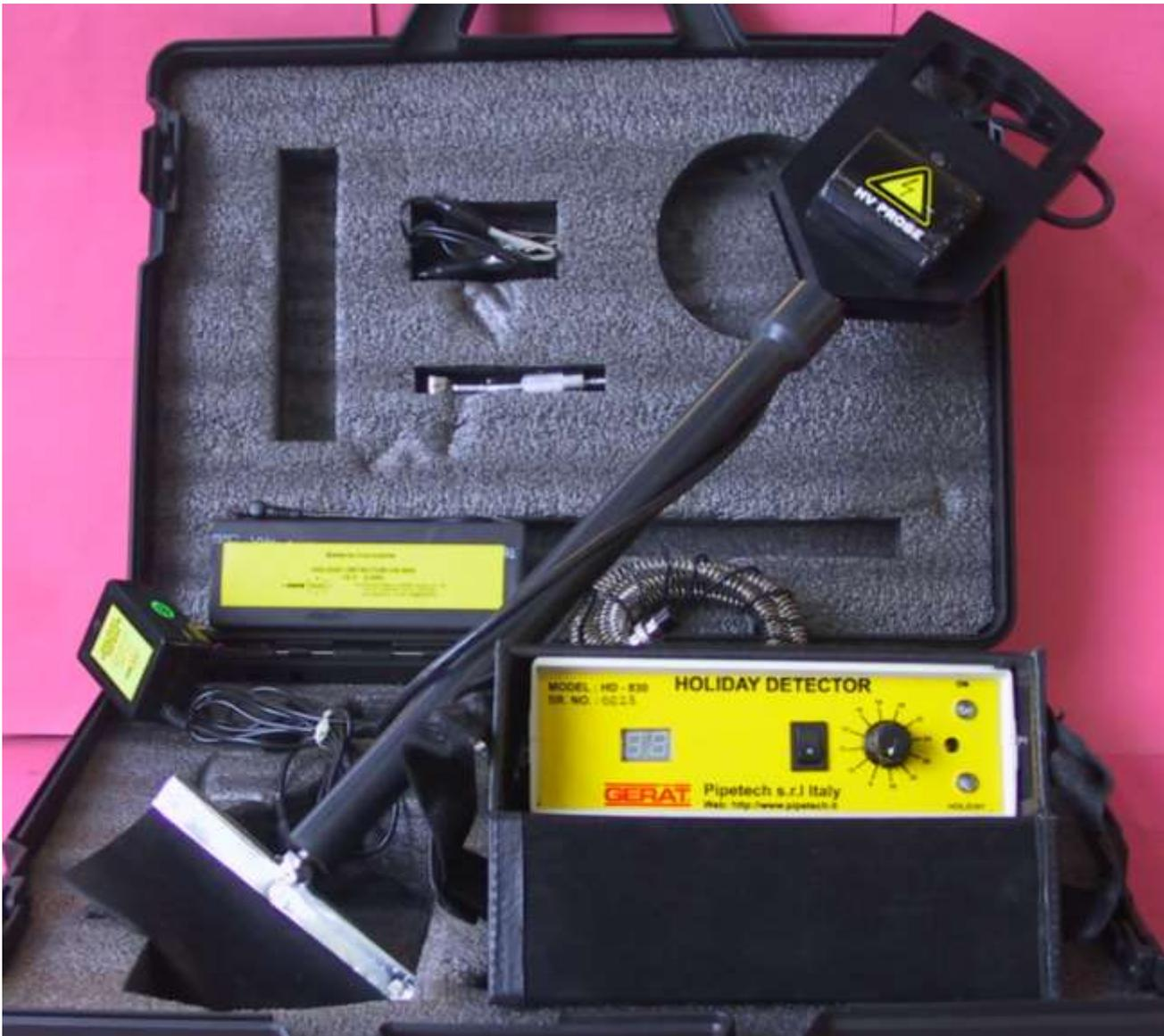
GHD-900 Gerat è uno Scintillografo – Analizzatore di Rivestimenti in grado di rivelare la presenza di falle nel rivestimento isolante della tubazione prima del reinterro. L’alta affidabilità e la semplicità d’uso sono le caratteristiche più evidenti di questo strumento già utilizzato da centinaia di Aziende di Distribuzione ed Imprese di Posa Tubazioni.
